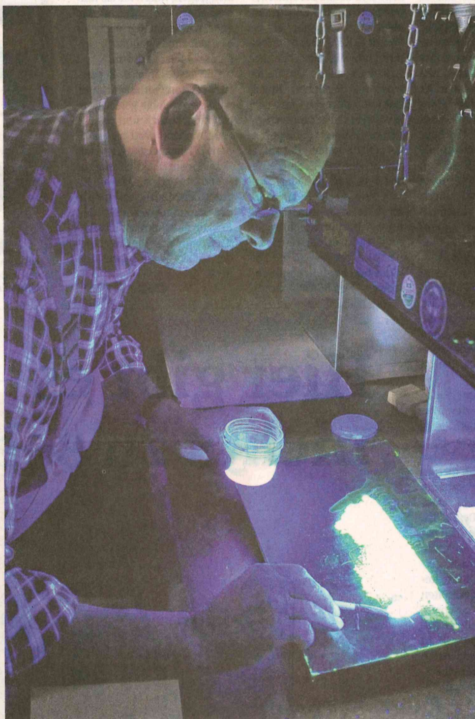
Rissprüfer Jörg Schrank prüft ein Ringsegment.
